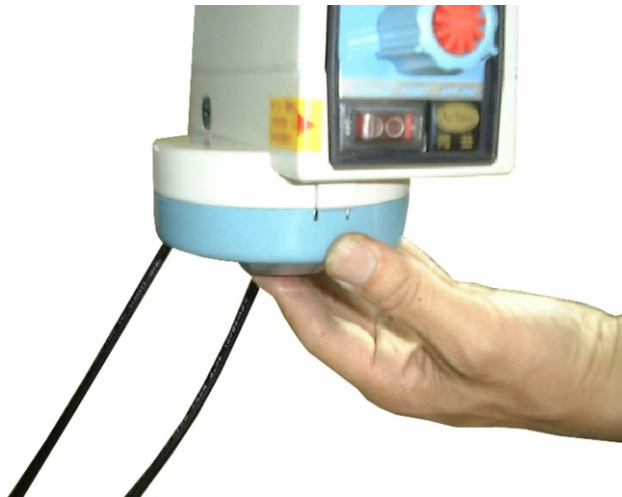
步驟 15 最後再套上齒輪蓋，並固定極限開關
