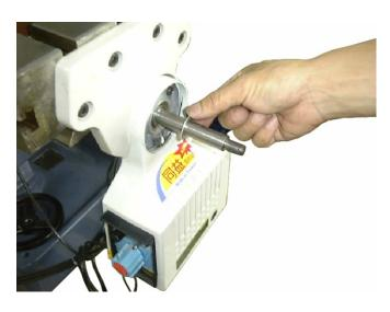
步驟 4 若齒輪間隙太小,則取適當厚度(1.0t,0.25t,0.1t) 之間隙墊圈套入,然後再重復步驟3,直到間隙達到要 求為止。
