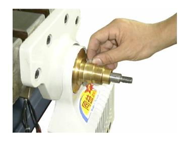
步驟 6 取出把手,放入適當之大間隙墊圈(Φ43×Φ33) 以調整刻度盤與傘齒輪之間隙,並鎖上固定環。
